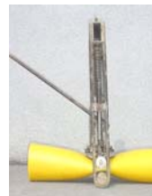
Professionelle Rohrquetschung (EVN Personal)
