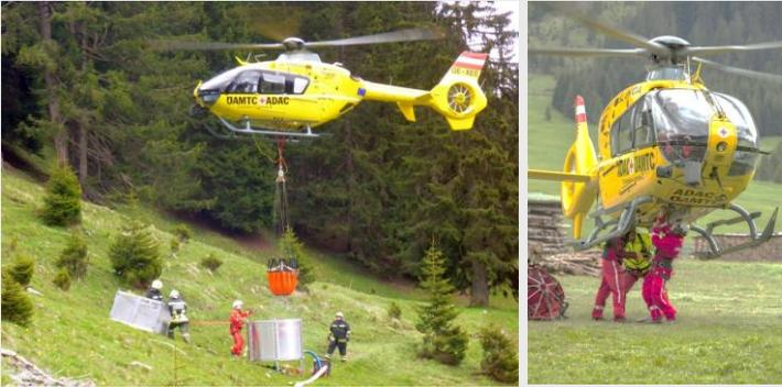
„Bambi Bucket“ = Faltbarer Löschwasserbehälter - gibt's von 270 bis 10.600 Liter Fassungsvermögen!
